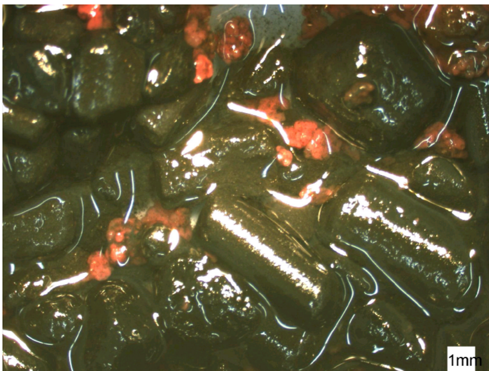
Abbildung 3: Probe aus einem Aktivkohleabsorber bei 20-facher Vergrößerung
